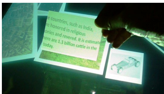
図3 Microsoft の SecondLight. テーブルに表示されている写真の上に半透明のシートをかざすと、付加情報を見ることができる。
